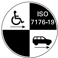
Märkning som visar att utrustningen är krocktestad enligt ISO 7176-19
