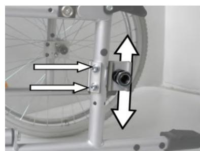
Zur Verstellung der Hinterachse nehmen Sie zuerst die Antriebsräder ab:
