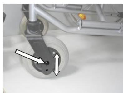
Nach Verstellung der Hinterachse müssen die Lenkräder ebenfalls in verstellt werden:
